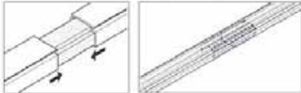
Le manchon s'insère dans le rail, il est alors invisible une fois le rail raccordé.
